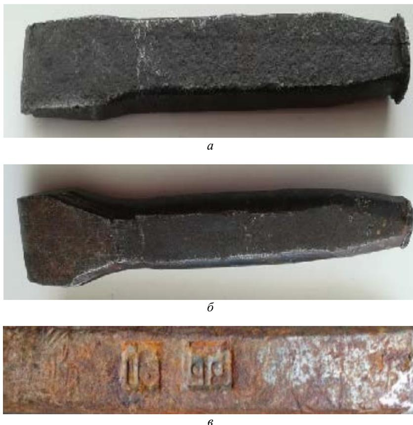
Рисунок 4 — Фото металлоизделий (зубило), экспонированных в пленки на основе ПЭНД, модифицированного нефтью: *a* – зубило до консервации; *b* – зубило после экспозиции (6 месяцев) в разработанной пленке состава ПЭНД–ЛН; *в* – зубило после экспозиции (6 месяцев) без упаковки на открытом воздухе
