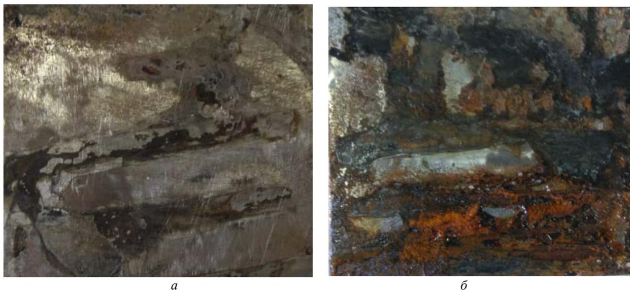
Рисунок 5 — Результаты климатических испытаний металлических образцов: *a* – экспонированных в таре, наполненной блочными образцами состава ПЭНД–шлам; *б* – экспонированных в таре без наполнения
