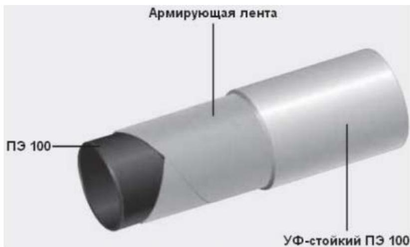
Рисунок 3 — Труба Soluforce RTP из [19]
