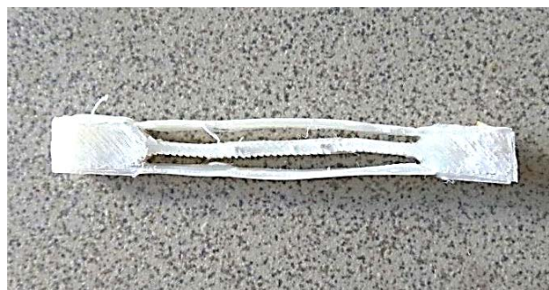
Рисунок 2 — Образец 3D-печати прутком из чистого ПЭНП
