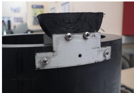
Рисунок 3 — Образец, закреплённый на поверхности несущей трубы с помощью металлической накладки и четырёх саморезов.
