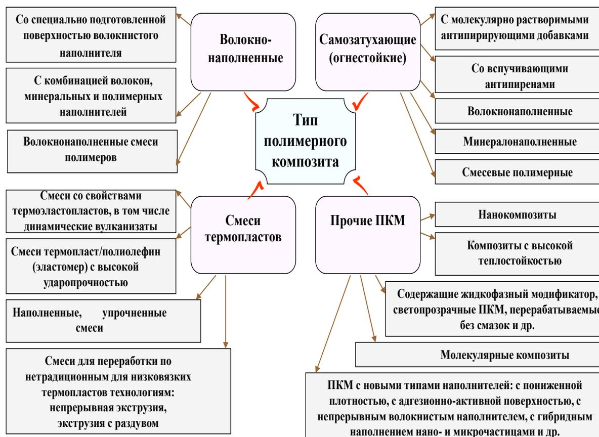
Рисунок 1 – Важнейшие типы полимерных ПКМ технического назначения
