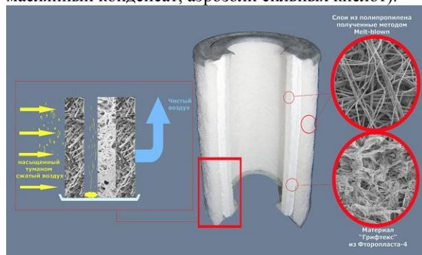
Рисунок 6 – Конструкция фильтр-элемента «Гриф» и схема его работы
