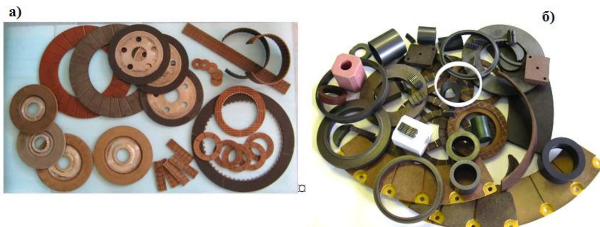
Рисунок 5 – Изделия из фрикционных материалов: а – для узлов трения колесных тракторов «Белорус»; б – для комплектации технологического оборудования ОАО «БМЗ»
