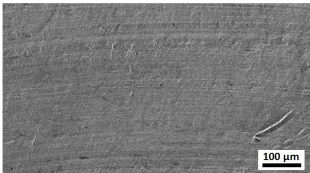
Рисунок 4 — Микрофотография поверхности трения образцов из ненаполненного ПТФЭ
