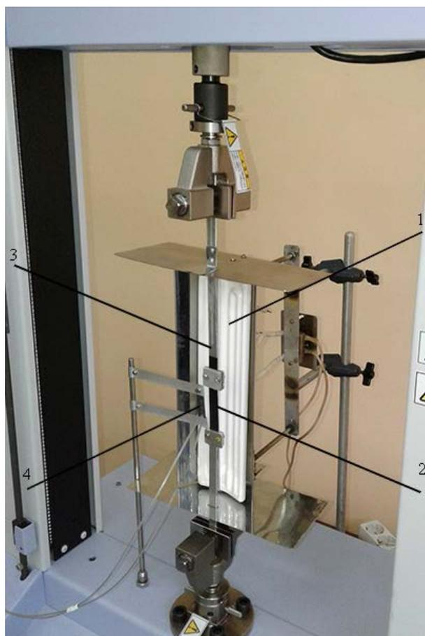
Рисунок 2 — Приспособление для испытания полимерных композитов на растяжение при высоких температурах: 1 – керамический ИК-излучатель с отражающими экранами; 2 – образец; 3 – держатели образца из материала с низкой теплопроводностью; 4 – датчик температуры
