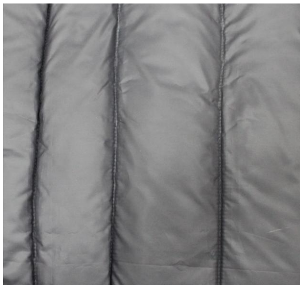
Рисунок 1 — Фотография стеганого пакета изделия на ППУ
