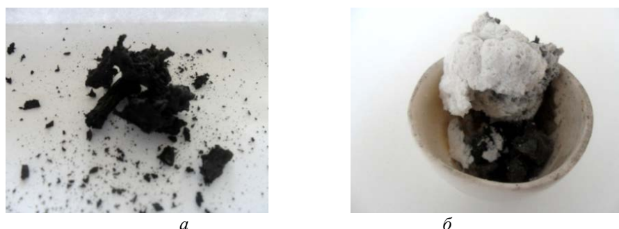
Рисунок 6 — Композиция AN-1 (а) и AN-2 (б) после нагрева при температуре 500 °С (30 мин) Fig. 6 — Composition of AN-1 (a) and AN-2 (b) after calcination at a temperature of 500 °C (30 min)
