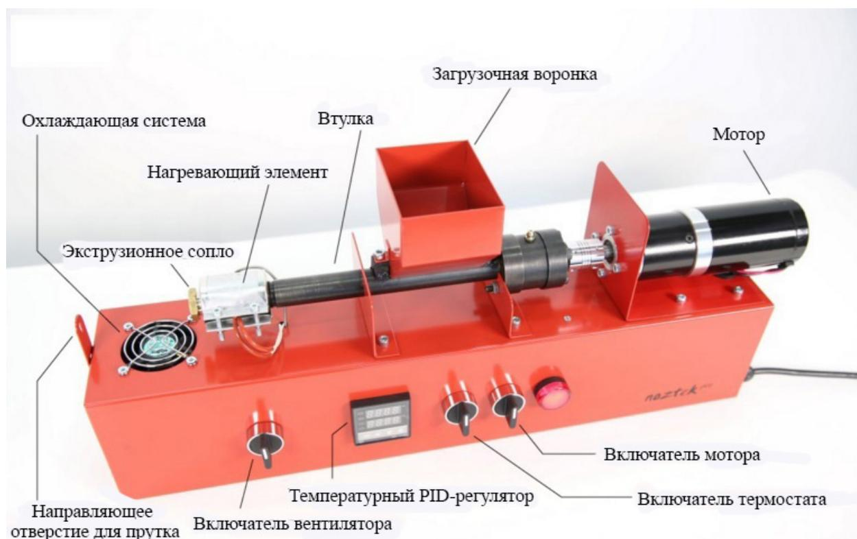
Рисунок 2 — Одношнековый экструдер «Noztek pro»
