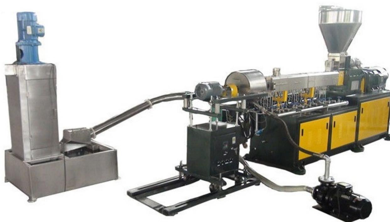
Рисунок 1 — Двухшнековый экструдер «SJSL-36»
