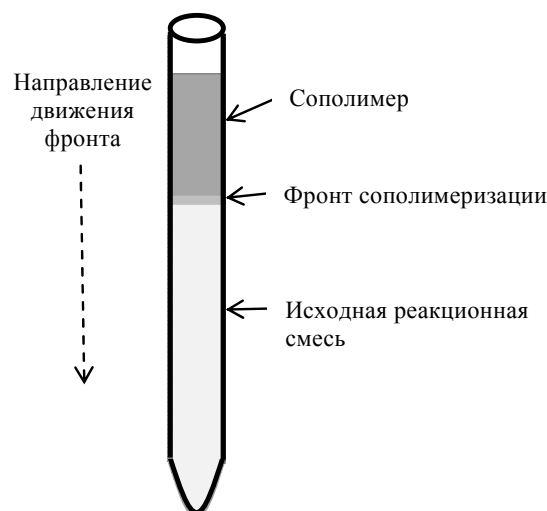
Рисунок 1 – Схема проведения процесса фронтальной сополимеризации
