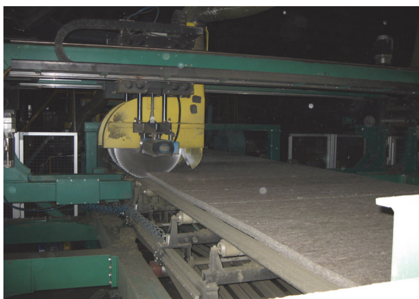
Рисунок – Нарезка плит после выхода материала из камеры тепловой обработки
