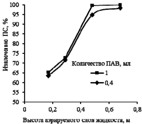
Рисунок 3 – Зависимости извлечения ПС от высоты аэрируемого слоя жидкости для количеств ПАВ 0,4 мл и 1 мл
