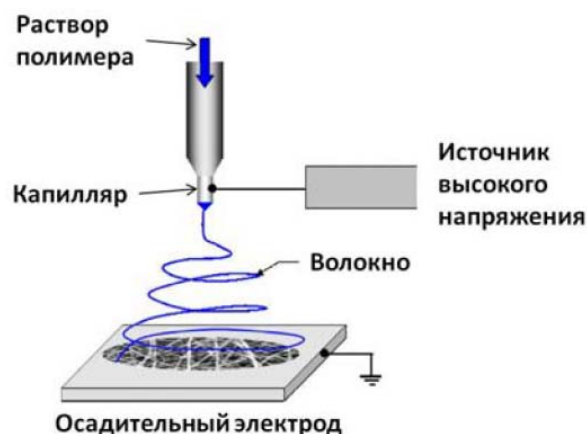
Рисунок 3 – Схема получения нановолокон полимеров методом электроформования
