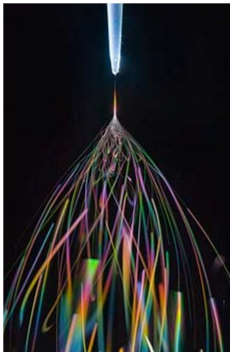
Рисунок 5 – Образование конуса Тэйлора и его дальнейшее расщепление
