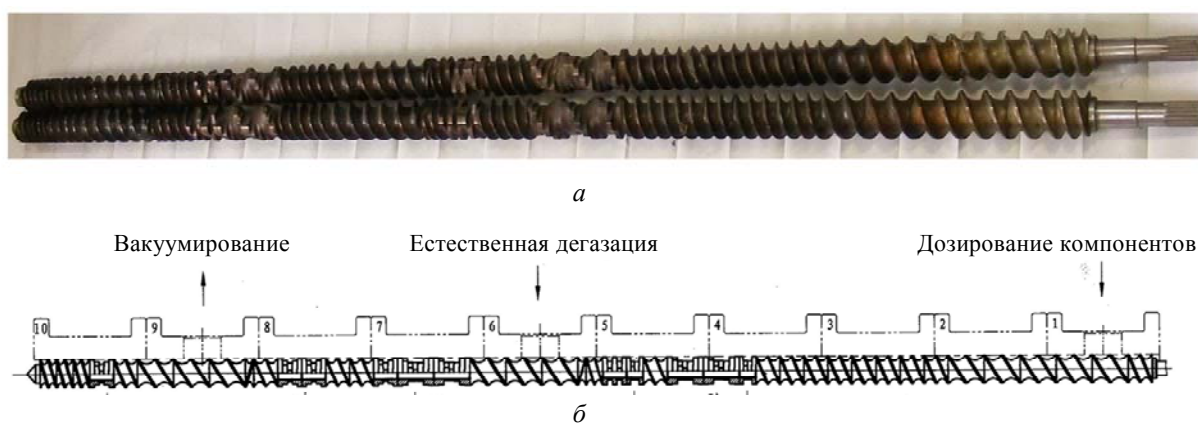
Рисунок 1 – Фотография (а) и схематическое изображение (б) конфигурации шнеков экструдера TSSK-35/40; 1–10 – секции шнеков
