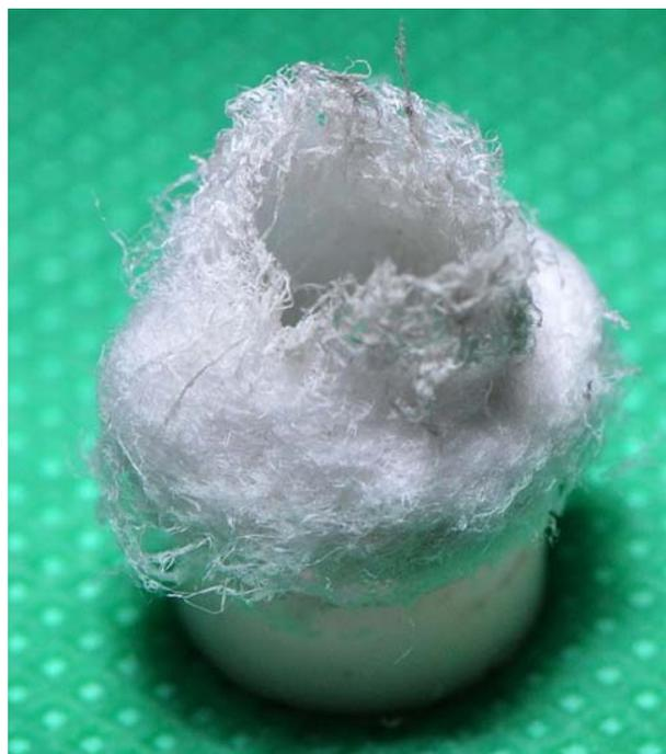
Рисунок 9 – Вид композиционной мишени после абляции
